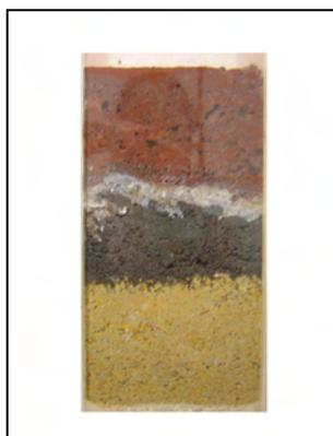
**Figura 6. Célula de acrílico apresentando cimentação (camada clara) entre duas camadas.**
