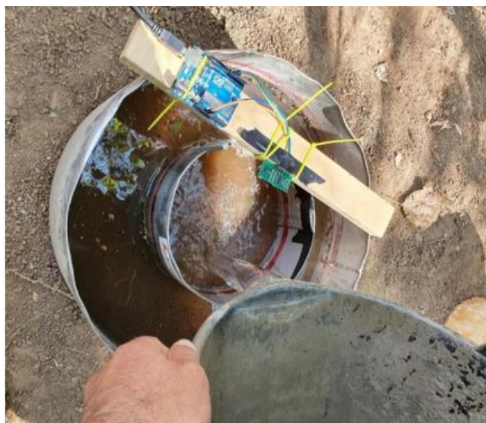
Figura 3. Exemplo de infiltrômetro de anéis concêntricos com medição automática.
