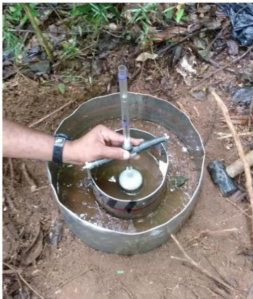
**Figura 3.** Realização do teste de infiltração com infiltrômetro de anéis concêntricos
