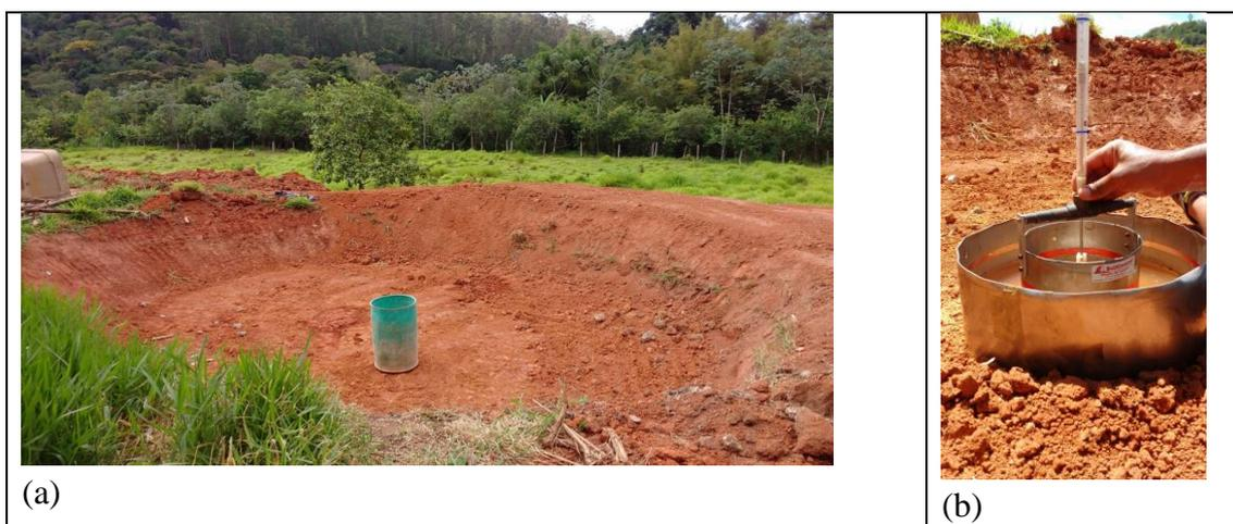
**Figura 4.** Área de bacia de Retenção (4a) em que se fez um dos testes de infiltração (4b).
