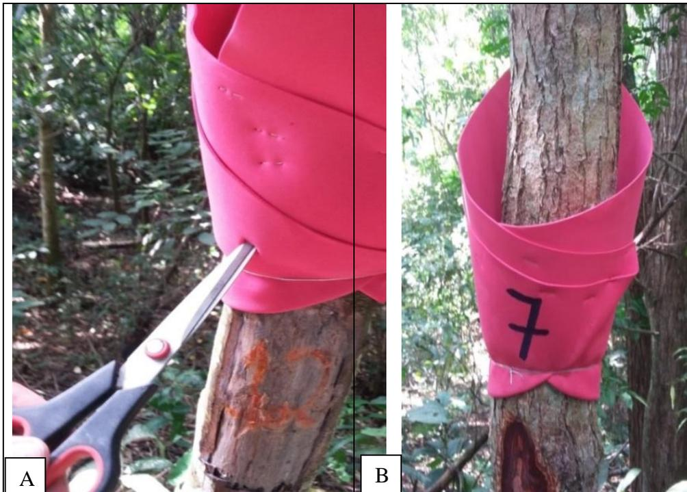
**Figura 7A.** Montagem e instalação do coletor de escoamento pelo tronco, perfuração do E.V.A.
