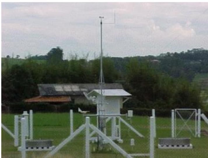
Figura 1. Posto Meteorológico física e automática na Fazenda Piloto da UNITAU, Taubaté, SP.
