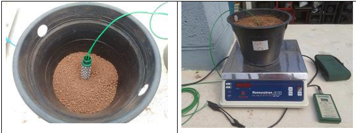
Figura 5. Sensor e medidor Watermark e procedimento de pesagem.
