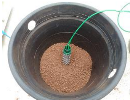
Fig. 2 Sensor de tensão do tipo Water Mark
