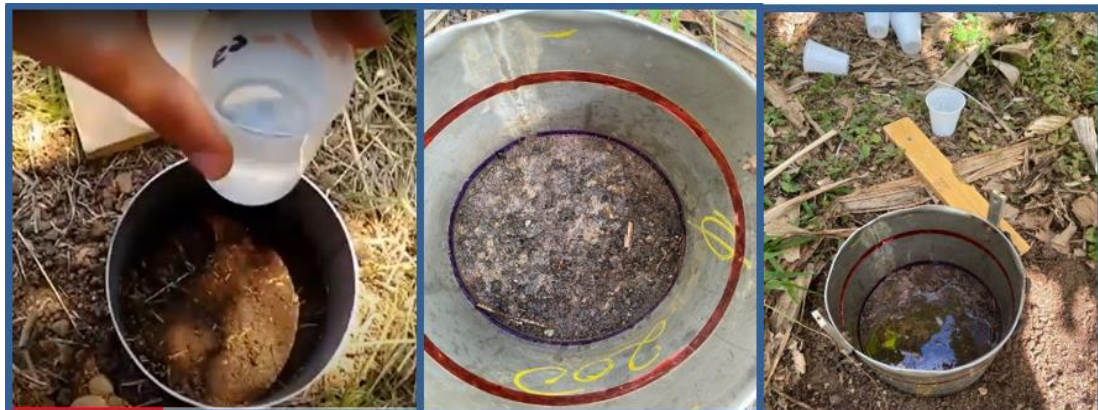
Figura 2. Metodo Beerkan manual com o uso de anel simples e leitura manual (copos plasticos) de infiltração de água no solo. Fonte: Autor
