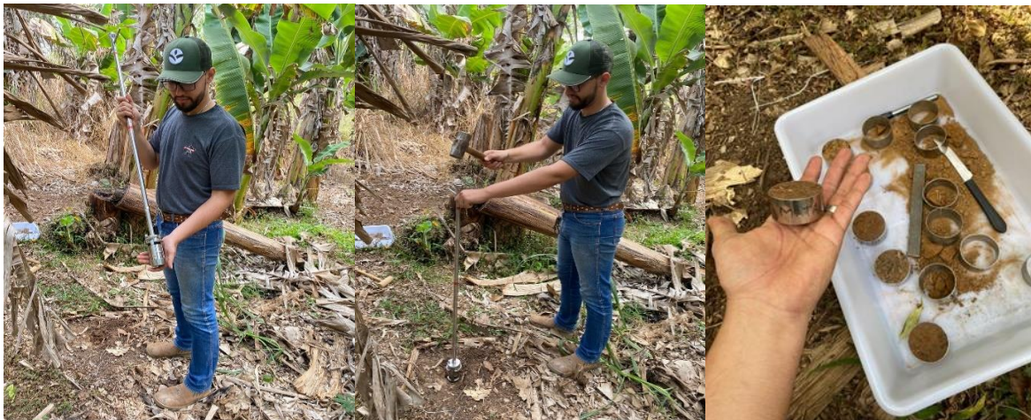
Figura 5. Procedimento de coleta de amostras dos solos para análises físicas.
