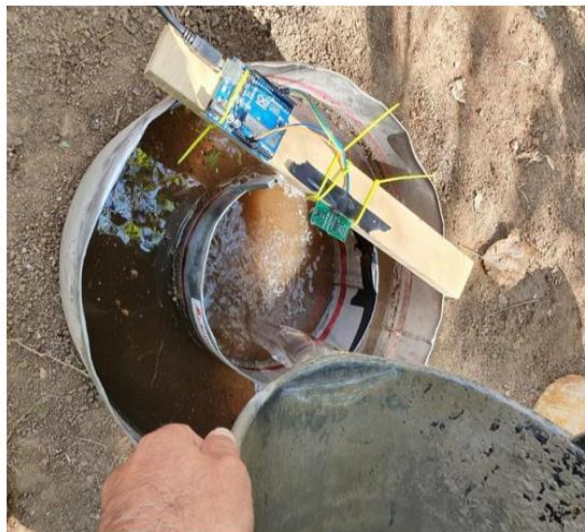
Figura 3. O uso de anéis concêntricos com leitura automática.
