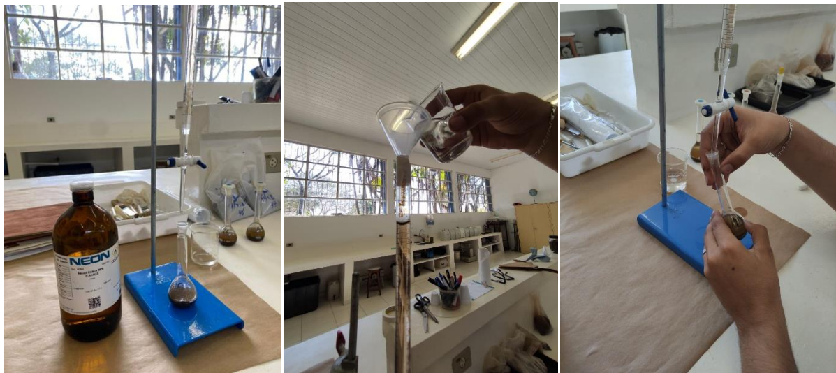
Figura 9. Procedimento de análise da densidade de partículas sólidas do solo.
