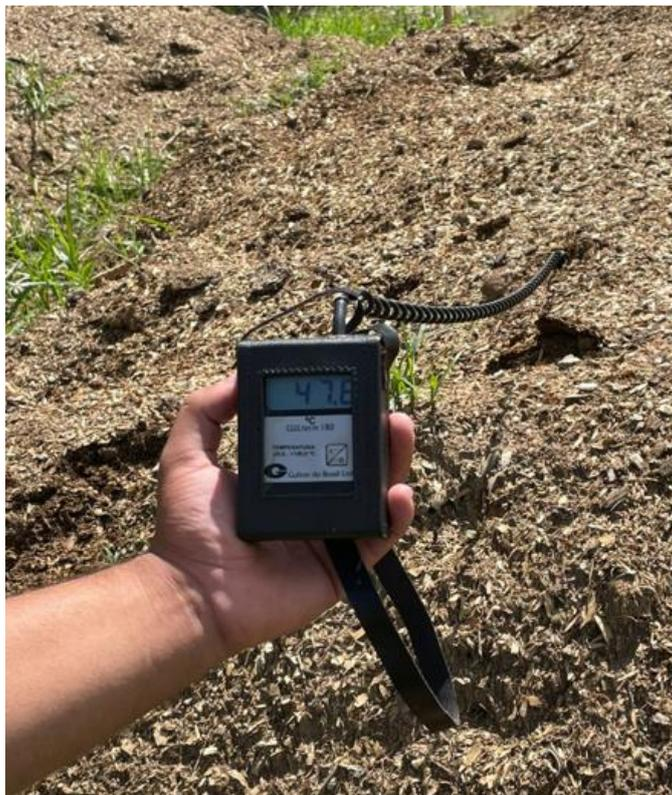
**Figura 2.** Termômetro utilizado na determinação da temperatura das leiras de compostagem.
